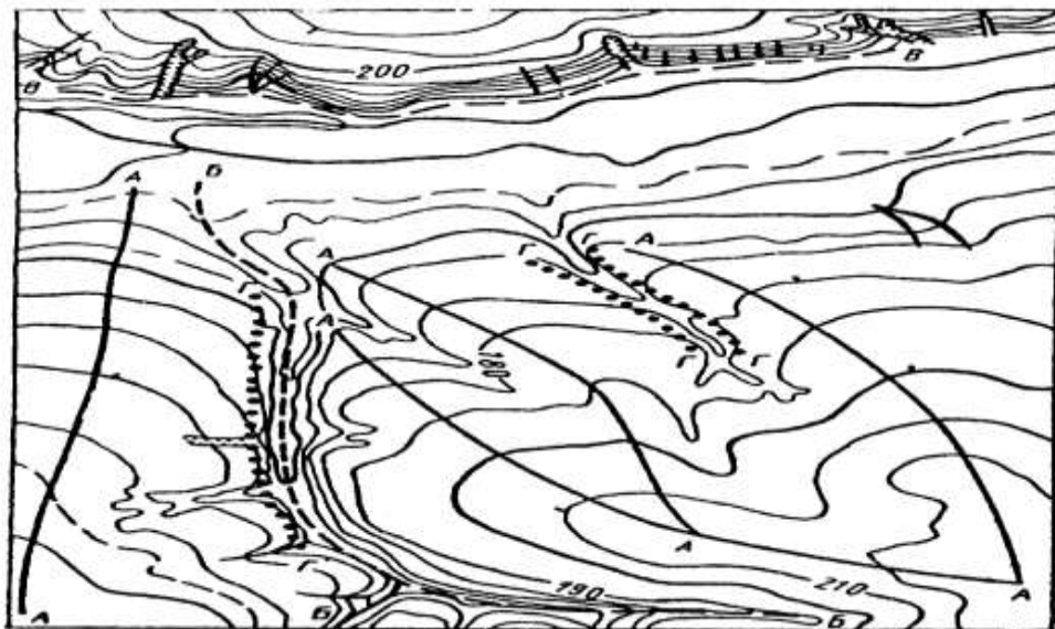
Рисунок 4 - Характерные линии рельефа: АА-водораздельная линия; ББ-линия тальвега; ВВ-подошвенная линия; ГГ-линия бровки
