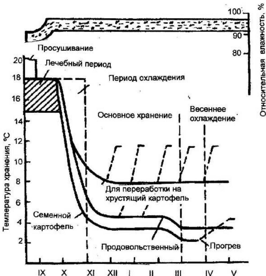
Рисунок 16 - Температурно-влажностный режим хранения картофеля:
