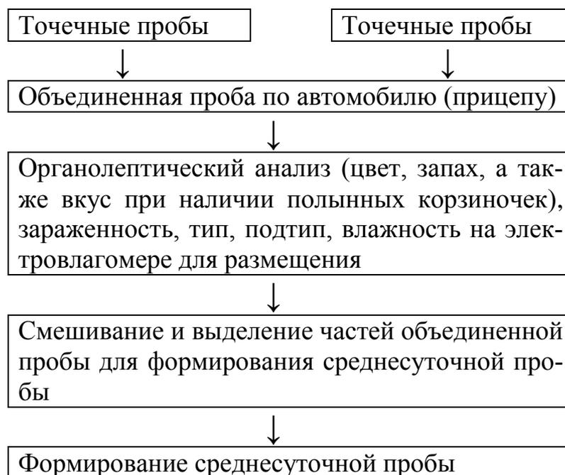
Рисунок 9 – Схема формирования среднесуточной пробы
