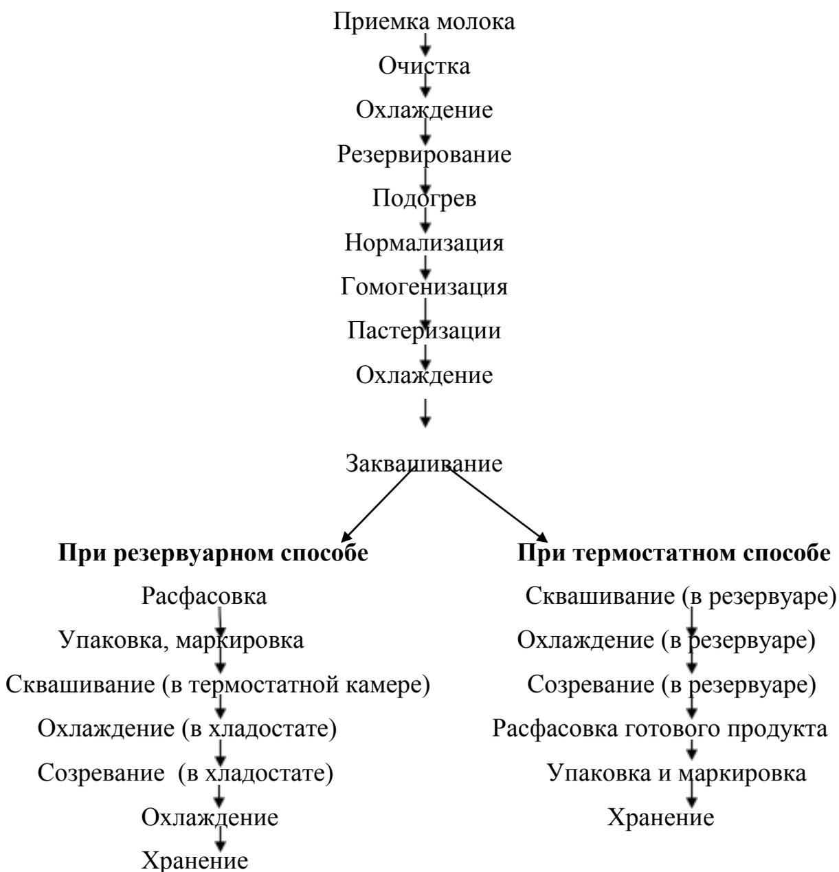
Рисунок 8 – Технологическая схема производства кисломолочных напитков
