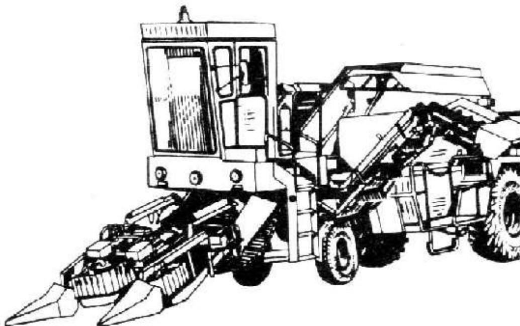
Рисунок 19 - Комбайн томатоуборочный КТУС-200: предназначен для сплошной уборки томатов, обслуживают- комбайнер и три сортировщика, производительность 10,2т/ч, ширина захвата 1,4...1,8м
