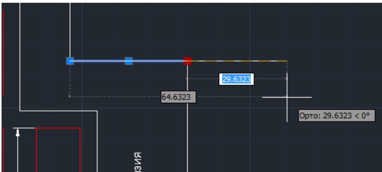
Рис. 17 Удлинение объекта с помощью «ручки»
