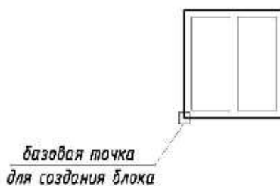
Рисунок 9.5 - Вычерчивание контура оконного проема
