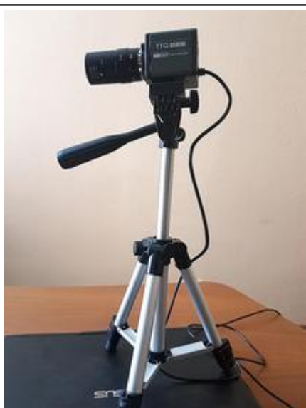
USB-камера с варифокальным объективом
