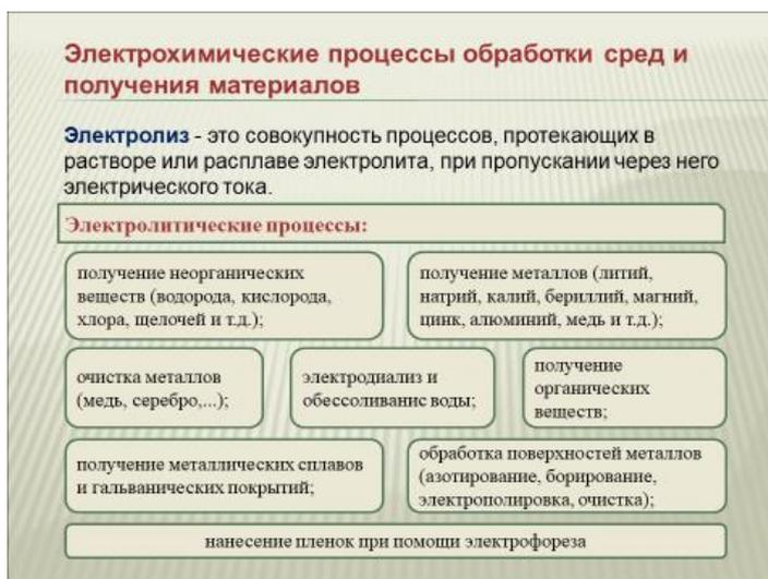
Электролитические процессы классифицируются следующим образом:
