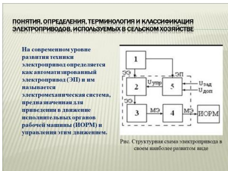
Электрическая энергия (ЭЭ) от источника электроэнергии 1 через преобразовательное устройство 2 (источник получения требуемых для электродвигателя параметров энергии и управления ее потоком) подается на электрический двигатель 3 (электромеханический преобразователь энергии). От электродвигателя механическая энергия (МЭ) через передаточное
