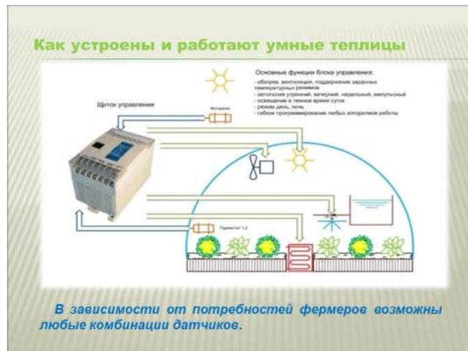
*Датчики.* В зависимости от потребностей фермеров возможны любые комбинации датчиков: температурные датчики, датчики влажности, датчики экспонометра, датчики состава почвы (кислотность, химический состав), датчики точки росы, датчики контроля качества воды для полива и так далее.
