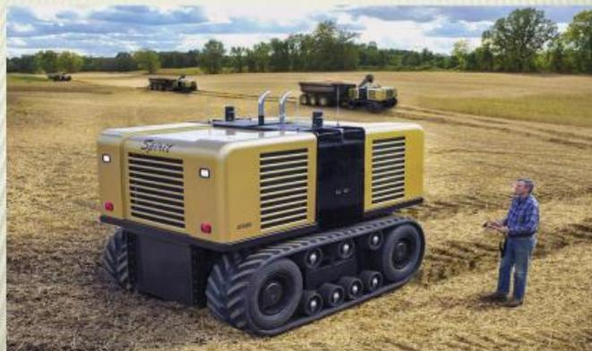
Данная система обнаруживает любые препятствия в зоне около 10 м от трактора, в результате чего машина немедленно останавливается и посылает СМС-сообщение. Оператор может ознакомиться с ситуацией с помощью, вращающейся и наклоняемой цифровой видеокамеры, закрепленной на корпусе.
