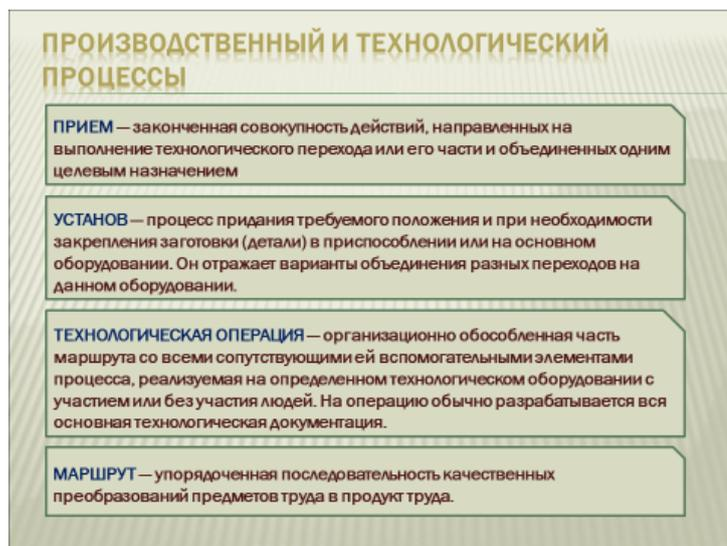
**Прием** — законченная совокупность действий, направленных на выполнение технологического перехода или его части и объединенных одним целевым назначением. Например, переход «установить заготовку» состоит из следующих приемов: взять заготовку из тары, переместить к приспособлению, установить в приспособление и закрепить.
