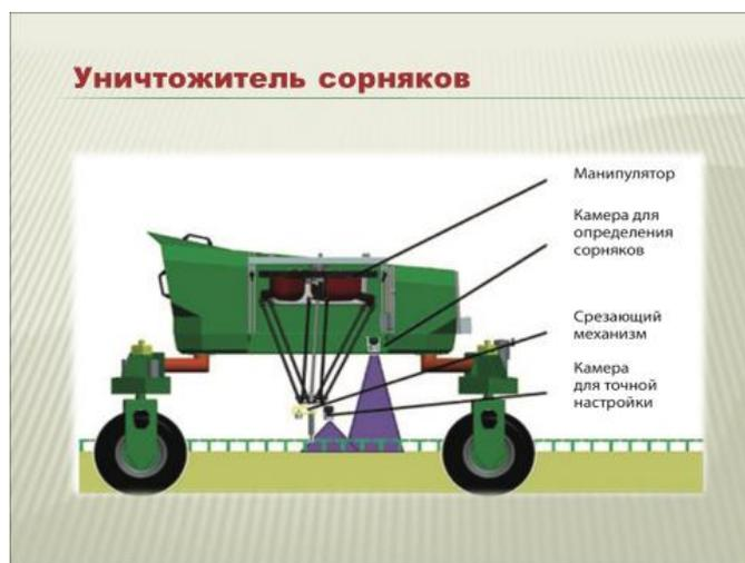
Основной целью машины при функционировании являются молодые побеги сорных растений, которые она при помощи камеры с высоким разрешением определяет по форме листа.
