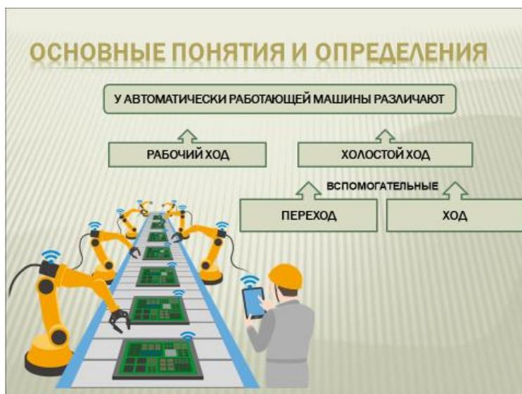
У автоматически работающей машины различают *рабочие и холостые* ходы. Последние состоят из *вспомогательных переходов и вспомогательных ходов*.
