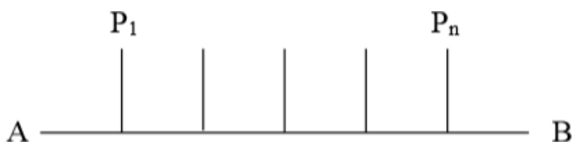
Рисунок 23 - Схема к перенесению в натуру методом перпендикуляров
