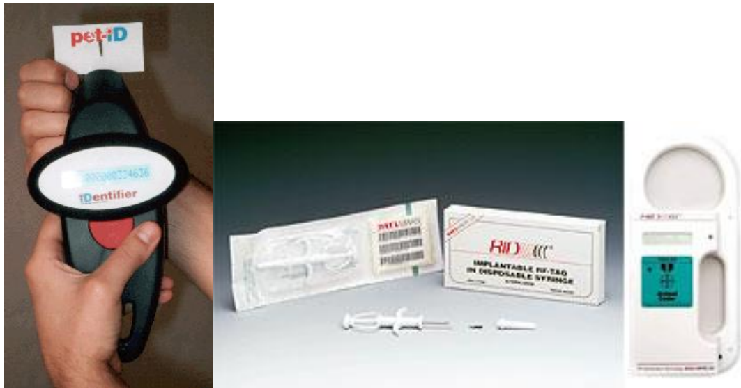
Рис.13. Сканирующее устройство для чтения информации с чипа.
