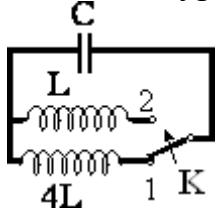
Ответ: Период колебаний в электромагнитном колебательном контуре, согласно формуле Томсона, прямо пропорционален квадратному корню из произведения индуктивности и емкости. Из рисунка видно, что при переведении ключа К из положения 1 в положение индуктивность уменьшается в 4 раза. Следовательно, в соответствии с формулой Томсона период колебаний уменьшится в 2 раза.
