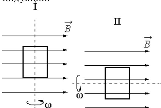
Ответ: Электромагнитная индукция – это явление возникновения электрического тока в замкнутом проводящем контуре при изменении магнитного потока, пронизывающего его. При повороте рамки в 1 случае магнитный поток, пронизывающий рамку, будет изменяться, а во 2 случае – не будет. Поэтому в 1 случае в рамке возникнет ЭДС индукции, а во 2 случае – нет.
