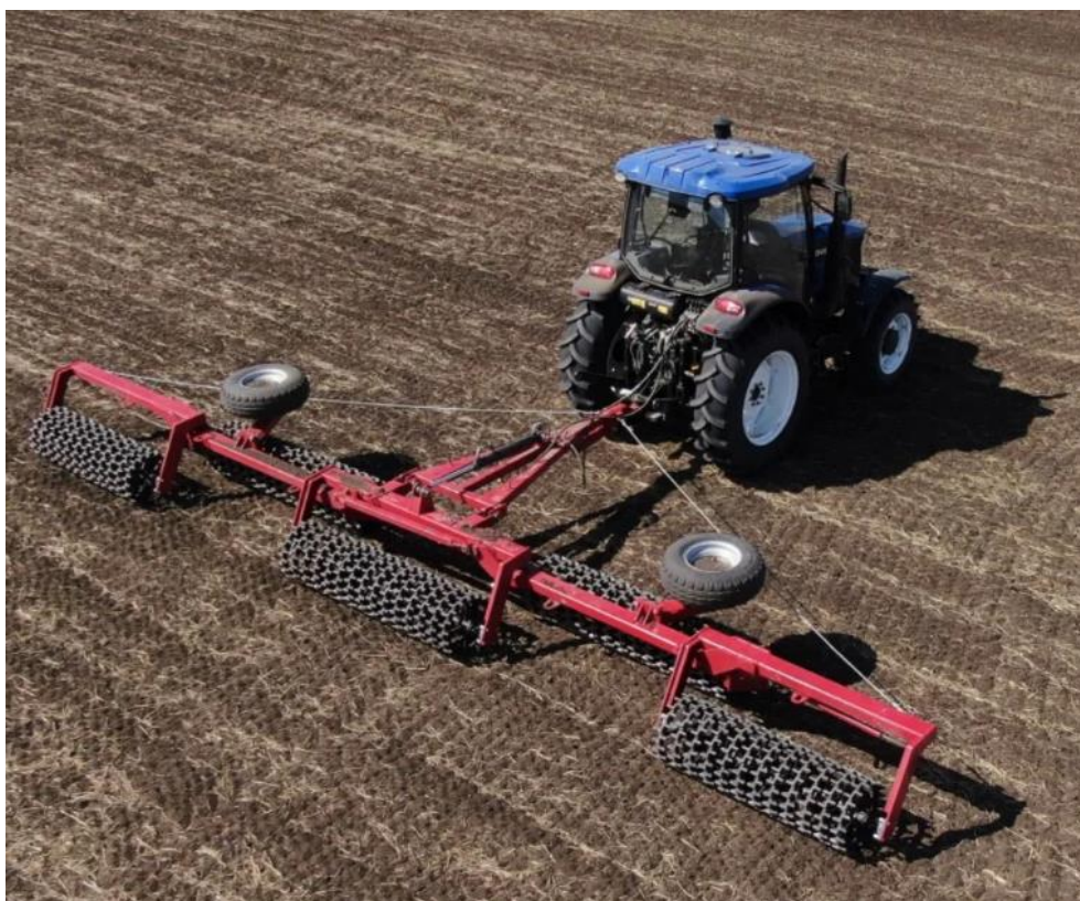
Рисунок 19 – Кольчато-шпоровый каток ККШ-9,2
