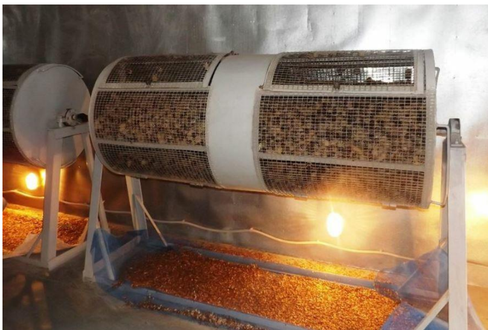
Рисунок 3 – Шишкосушилка Калининского типа
